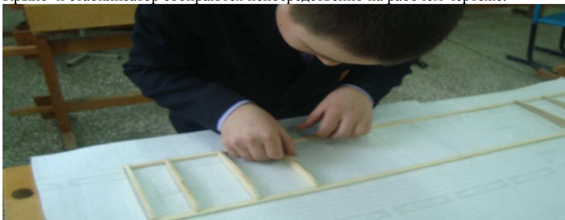
Крыло и стабилизатор собираются непосредственно на рабочем чертеже.
